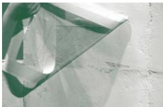
Bei der Folienprobe ist zu beachten, dass der Klebstreifen ringsum verläuft.
