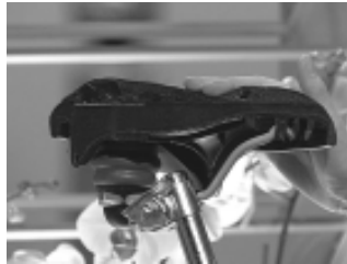
Das Innenleben eines Gelsattels
